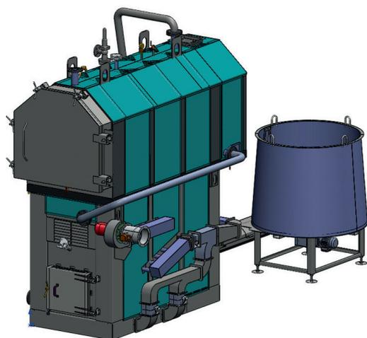
Основа установки — тяжелообмурованная топочная камера с наклонной чугунной колосниковой решеткой. Топка — изолированная, двухкамерная, с рабочей температурой 900–1000°C. За счет тяжелой обмуровки и арочного свода допускает сжигание высоковлажного топлива без какой-либо подсветки. По согласованию с Заказчиком топка может быть футерована шамотным кирпичем с рабочей температурой до 1400° С.
